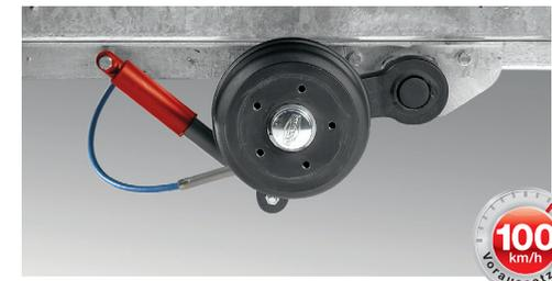
**Noch mehr Fahrkomfort** durch zusätzliche Radstoßdämpfer und 100 km/h Zulassung\* bei sehr guter Straßenlage mit der bereits standardmäßig tiefergelegten Gummifederachse.
