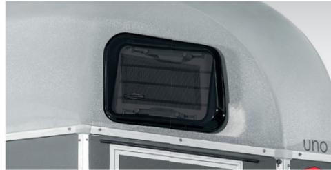
**Frischluff** durch die großen, blendfreien 5-Wege-Fenster (nach vorne, hinten, oben, unten sowie komplett aufstellbar) mit Sicherheitsgitter.
