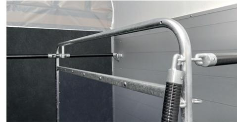
**Sicherer Transport** durch die bewährte Böckmann Trennwand und das vorne um 15 cm höhenverstellbare Sicherheitsboxenstangensystem mit Anbindungen.
