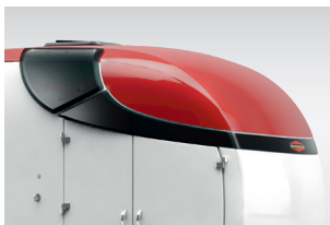
Seitenfenster mit durchgehendem Fensterband: natürlicher Lichteinfall in den Sattelraum (bei Sattelkammer in den Pferderaum)
