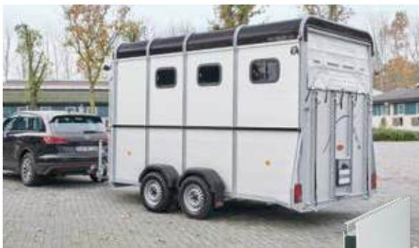
**Robuster Aufbau aus eloxiertem Aluminium Doppelstegprofil**
